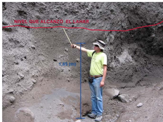
**FOTO 6.-** Sección considerada para el cálculo de velocidad, área de inundación y caudal pico. Sector Qbda. Motilones. Nótese la altura que alcanzó el lahar. (Foto: J. Bustillos)
