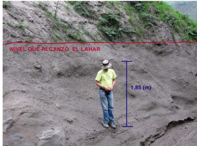
**FOTO 5.-** Sección considerada para el cálculo de velocidad, área de inundación y caudal pico. Sector Qbda. Bilbao. Nótese la altura que alcanzó el lahar. (Foto: J. Bustillos)
