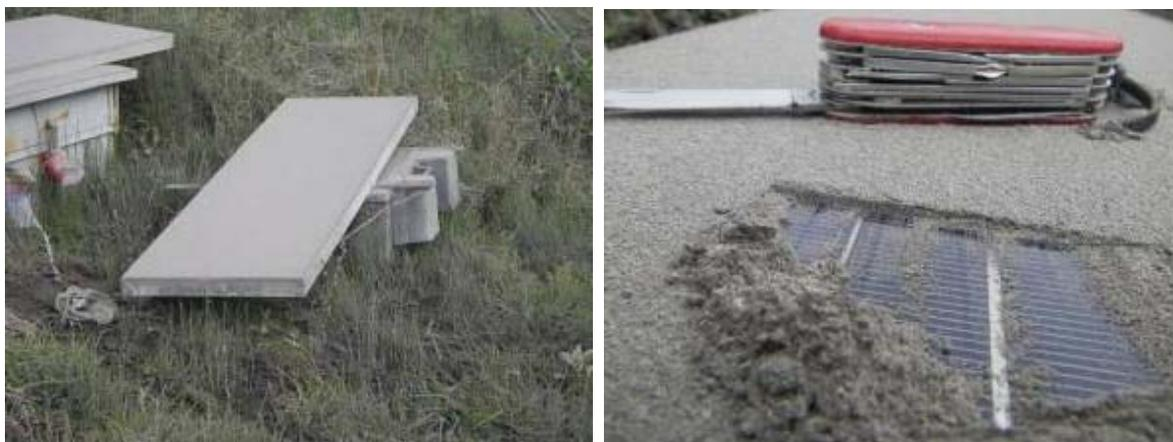
*Figura 10: Desde la madrugada y en el lapso de unas 12 horas se depositaron 3 mm de ceniza en los paneles solares de las estaciones de Bilbao (Fotos: P. Ramón OVT/IG)*
