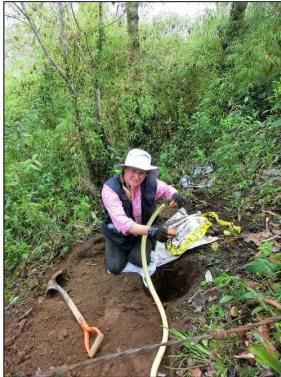
**Fig. 13:** *Instalación de nuevo sensor AFM en Vascún Oriental. (Foto: P. Cruz, IG-OVT).*
