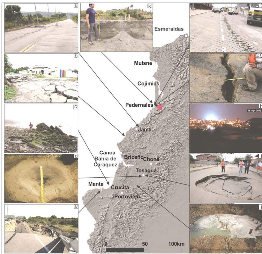
Fig. 1: Efectos ambientales cosísmicos durante el terremoto de Pedernales: (a) fracturas transversales en la vía Jama; (b) lateral spreading y subsidencia en CIBV de Jama; (c) estratos rocosos levantados en la plataforma de abrasión en Crucita; (d) volcán de arena en Tosagua; (e) lateral spreading y daños en el puente Mejía; (f) levantamiento y deformación de adoquines en malecón de Pedernales; (g) grietas en suelo natural en Chamanga; (h) emisiones de luces observados desde Guayaquil; (i) sinkhole en Tosagua; (j) anomalía hidrológica y emisión de gas en el sector sur de Tosagua; y (k) levantamiento de costa de 1.4m en Pedernales.
