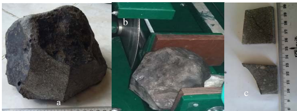
Fig. 2: (a) meteorito con caras previamente cortadas, (b) proceso de corte y (c) chips para estudio
