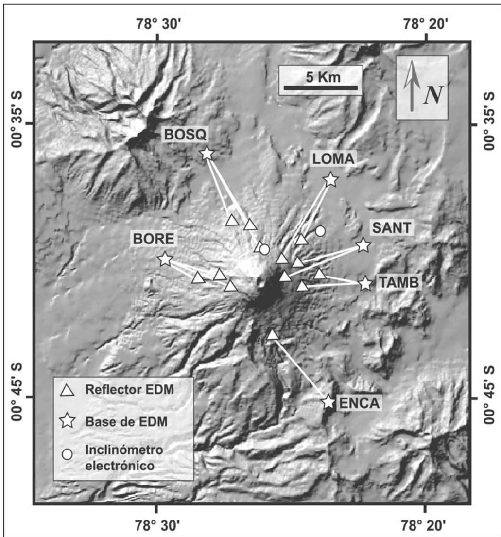
**Figura 24.** Mapa con los sitios de instalación de inclinómetros electrónicos y con la red de líneas de control EDM del Cotopaxi.
