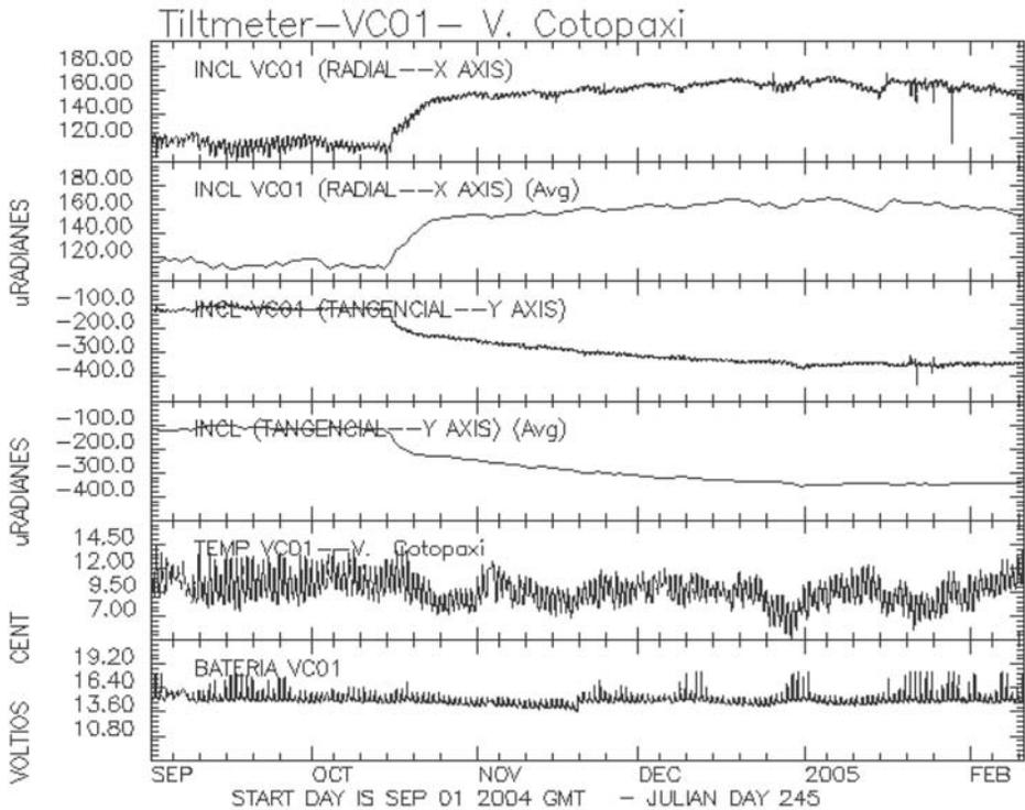
**Figura 25.** Ejemplo del registro obtenido por uno de los inclinómetros del Cotopaxi, entre septiembre de 2004 y febrero de 2005. Se puede interpretar que a lo largo de este período ocurrió un ligero cambio en la inclinación del punto de medida a principios de octubre de 2004. Estos instrumentos realizan medidas, en promedio, quince veces por hora (una medida cada cuatro minutos), y envían datos de inclinación radial, tangencial y de temperatura atmosférica local.
