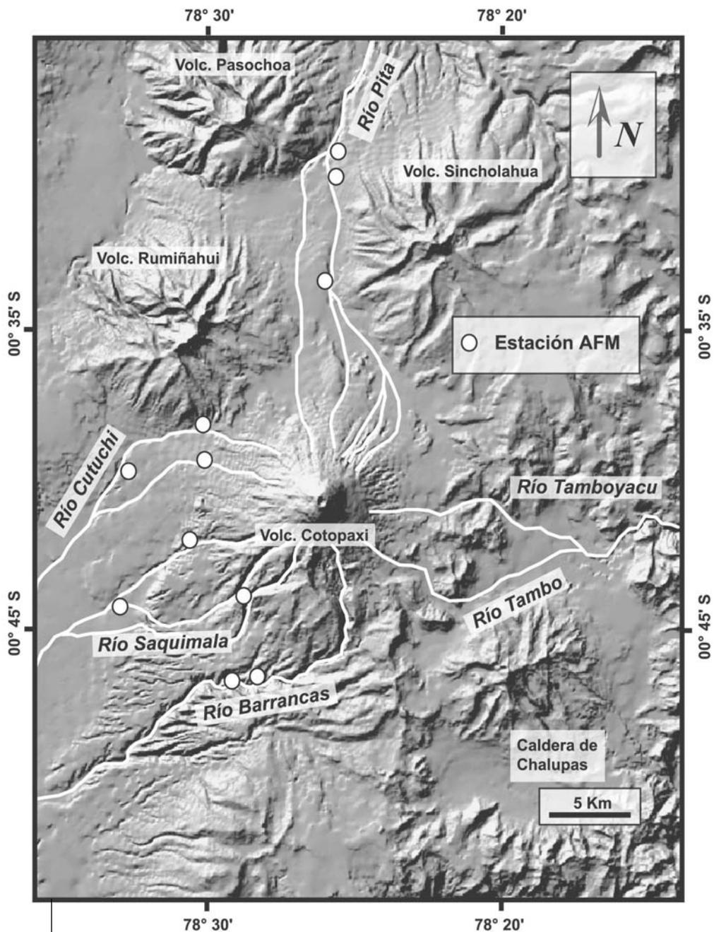
**Figura 32.** Red de detectores de lahares AFM del Cotopaxi. Se han instalado un total de 11 instrumentos en los principales drenajes que alimentan los ríos Pita y Cutuchi. En el futuro se piensa extender esta red para vigilar también los ríos del drenaje oriental (ríos Tambo y Tamboyacu).
