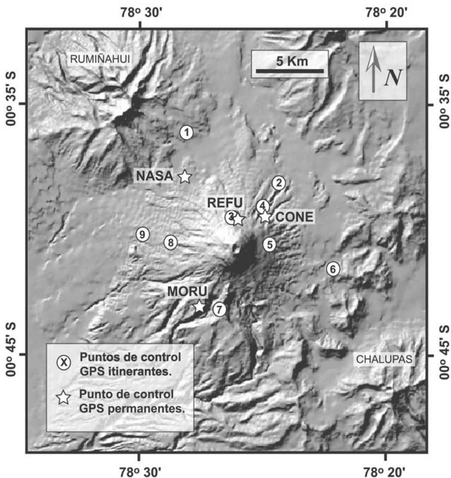
**Figura 28.** Red de puntos de control mediante GPS. El Instituto Geofísico cuenta con 4 estaciones GPS permanentes (adquisición de datos permanente) y una red de 9 puntos donde se realizan mediciones itinerantes (adquisición de datos itinerante).
