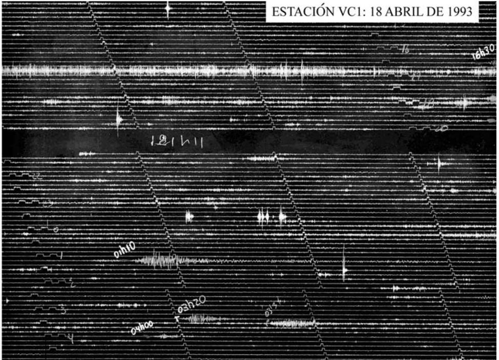
**Figura 33.** Registro de la actividad sísmica del Cotopaxi obtenida por la estación VC1 (ver Fig. 23) en abril de 1993. Se nota que en ese tiempo había poca actividad sísmica en el volcán. La ventana de tiempo del registro mostrado en este ejemplo es de aproximadamente 7 horas.
