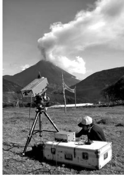
**Figura 29.** El *sensor remoto* COSPEC (espectrómetro de correlación, por sus siglas en inglés) mide a distancia el contenido de gases magmáticos en las emisiones volcánicas. Un alto contenido de gases magmáticos (p.e.  $\text{SO}_2$ ) puede significar que un período de actividad volcánica se aproxima. Izquierda: medidas realizadas en el Cotopaxi. Derecha: medidas realizadas en el Tungurahua. (Fotos: P. Mothes y D. Andrade).
