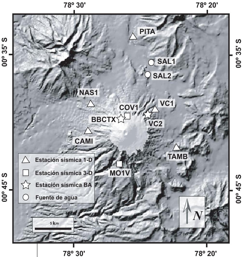
**Figura 23.** Mapa con la ubicación de todas las estaciones sísmicas instaladas en el Cotopaxi y de las dos fuentes de agua que son utilizadas como parte del monitoreo geoquímico. Las estaciones sísmicas del Cotopaxi son de tres tipos: “1-D” (detecta movimiento vertical), “3-D” (detecta movimientos verticales y en dos ejes horizontales), y “BA” (sensor banda ancha de 3-D, instalados bajo un convenio de cooperación con el gobierno alemán).
