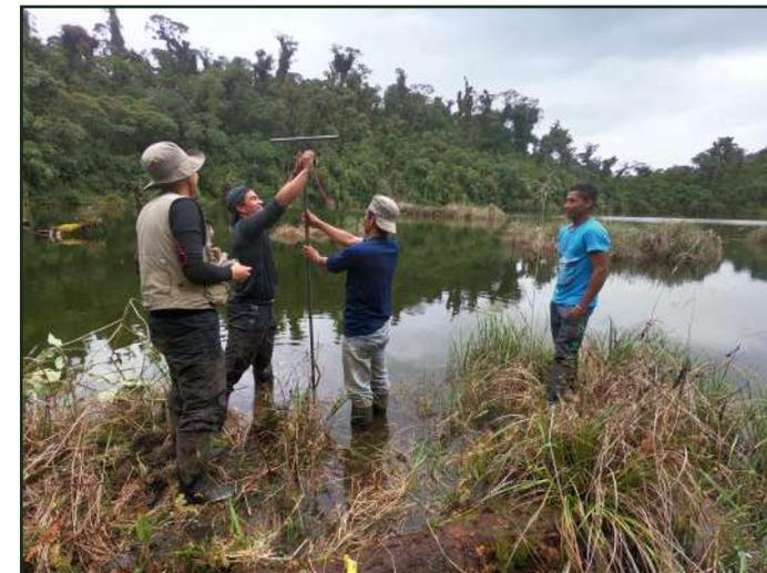
Fig. 4 Perforación manual realizada en las orillas de la Laguna Guagua Sumaco, flanco sur-este del volcán (3.500 msnm). La perforación alcanzó una profundidad de 3 metros. (Foto: S. Santamaría, 2018. IG-EPN).
