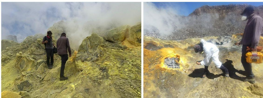
Figura 27. Mediciones con MultiGAS y mediciones directas de temperatura del Campo Fumarólico Minas de Azufre.
