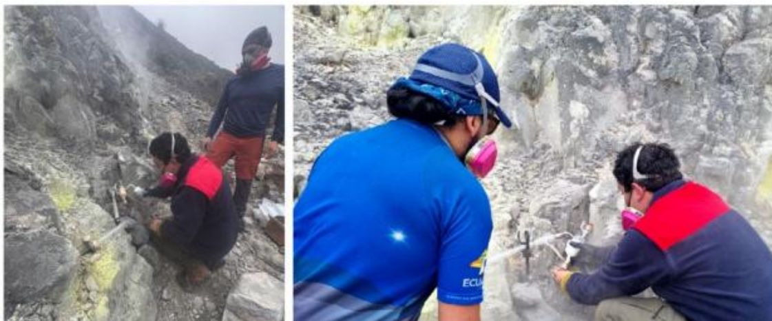
Figura 21. Muestreo directo de gas en las fumarolas del Volcán Guagua Pichincha, utilizando el método de la botella de Giggenbach 15/05/2025
